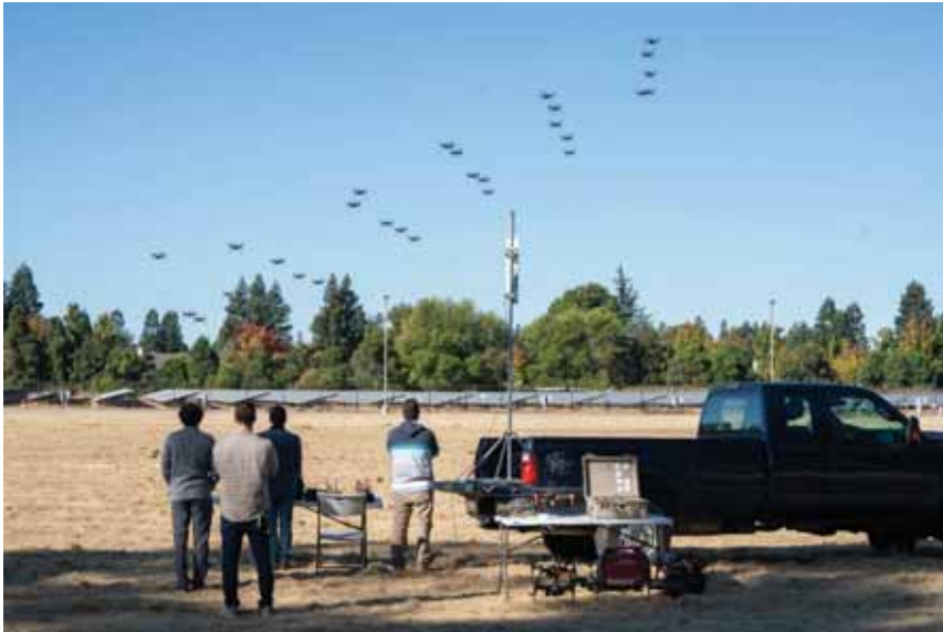
图2: LLNL自主传感器项目的成员正在进行集群测试——一名机长(PIC)控制着整个集群,同时三名视觉观察员向机长传递相关信息。(来源: Blaise Douros/LLNL)
