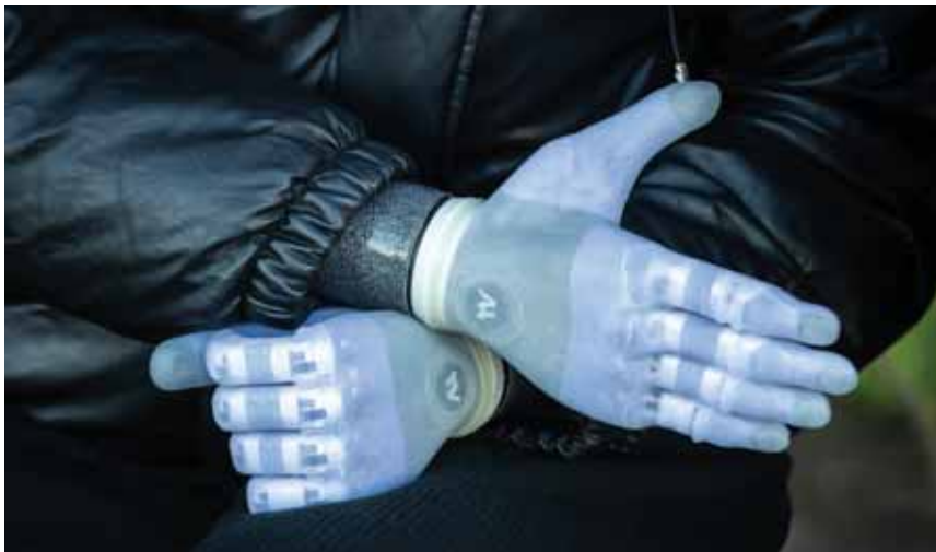
图4：亚当之手目前拥有一个单节拇指和四个双节手指，可以举起重达45kg的物体。（来源：BionIT Labs）
